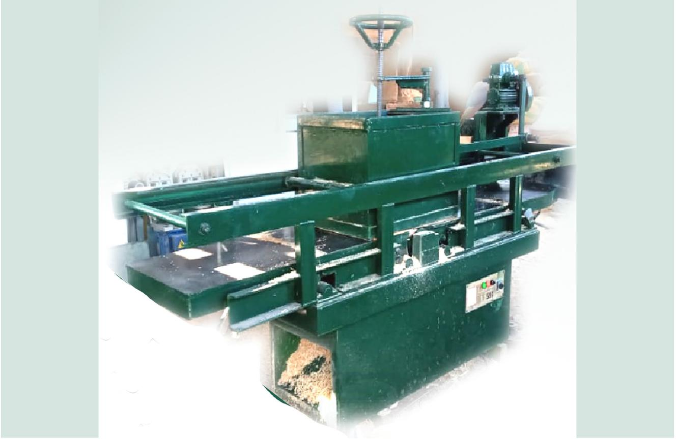
حيث مرت عملية تصنيع أجزاء الماكينة بعدة مراحل منها: خراط وإعادة صب الطنابير الألومنيوم وتصنيع كستير مخصص للفرم، وتصنيع سيارة لرص هالك الخشب وفرمه من هالك الصاج وقطع من الزوايا الحديد تم لحامها وتوصيلها وجعلها طبقاً لأصول الصناعة.
